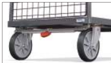
TOTALSTOP – het fetra centrale remsysteem Met slechts één voetbeweging wordt de wiel- draaiing en de zwenkbeweging van beide zwenkwieken geblokkeerd. Het rempedaal blijft altijd in het zicht van de gebruiker.
